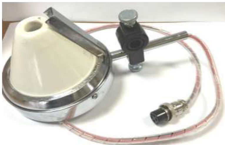
Рис. 4 Воронка горячего фильтрования (вспомогательный нагреватель) с крепежом и кабелем
